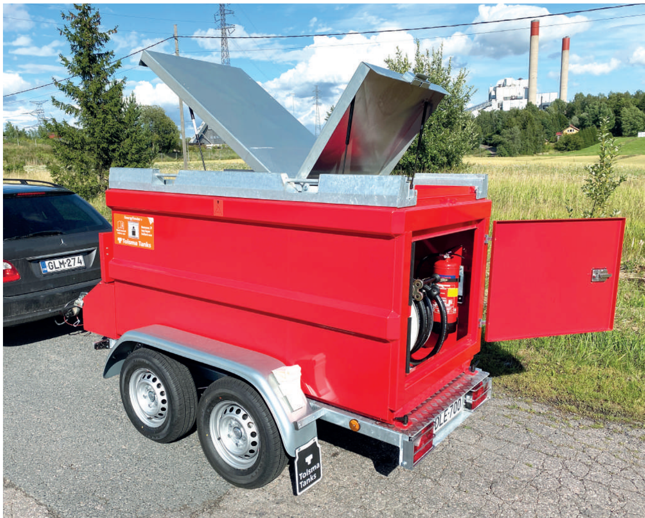
Suomessa suosituin TENDEX+ integroitu säiliökärry on ollut kuvassa näkyvä 995 litran versio, mitä saa kuljettaa vapaasti ilman VAK-lupia / ADR tutkintoa (vapaaraja 1000 L). Sillä kulkee turvallisesti suuri määrä polttoainetta työmaalle.
