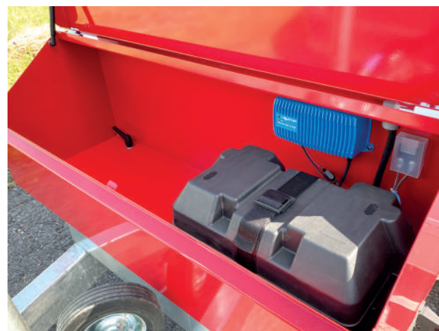
Lisävarusteena saa akkupaketin ja laturin, jolloin perävaunusta voi tankata silloinkin kun virtalähteenä toimivaa ajoneuvoa ei ole lähettyvillä.
