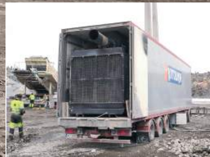
Iso liikuteltava säiliö on helpottanut ja tehostanut murskainlaitoksen polttoainehuoltoa merkittävästi.
