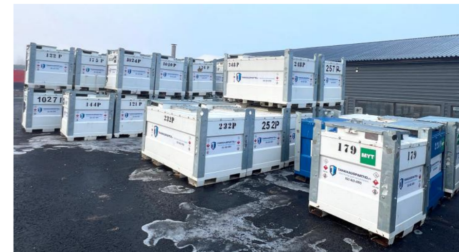
Tankkauspartiolle on käytössä satoja Infralinen 1000 - 3000 litran teräksisiä UN-tyyppihyväksytyjä valuma-altaallisia teräksisiä säiliöitä varustettuna tankkauslaitteilla, joilla polttoainetta toimitetaan työmaakäyttöön.
