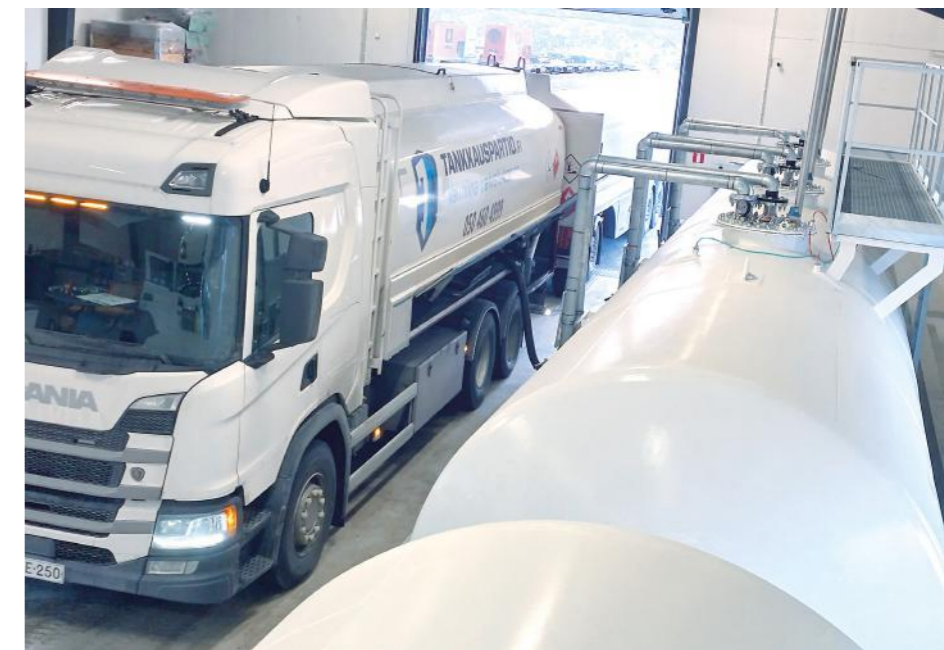
Työmaille polttoainetta jakelevat säiliöautot tankkaavat välivarastona toimivista suursäiliöistä polttoöljyä, dieseliä sekä ympäristöystävällistä MyDieseliä kesä- ja talvilaatuisina.
